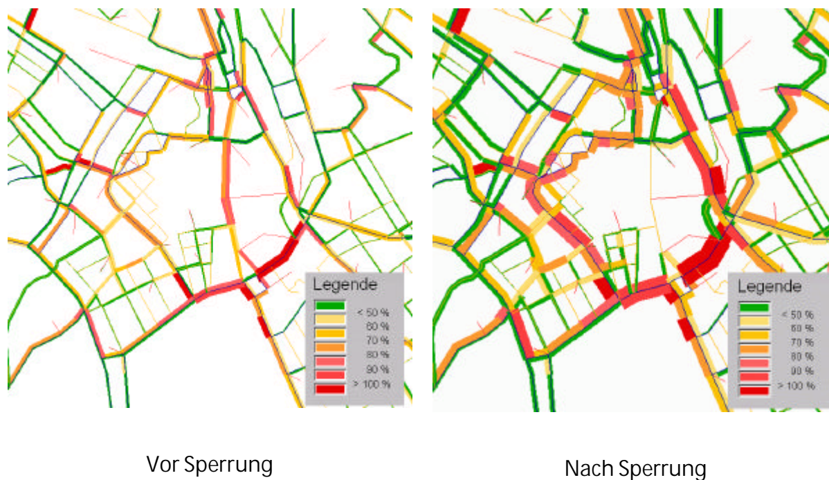
Abbildung 6-2: Streckenauslastung vor und nach der Sperrung
