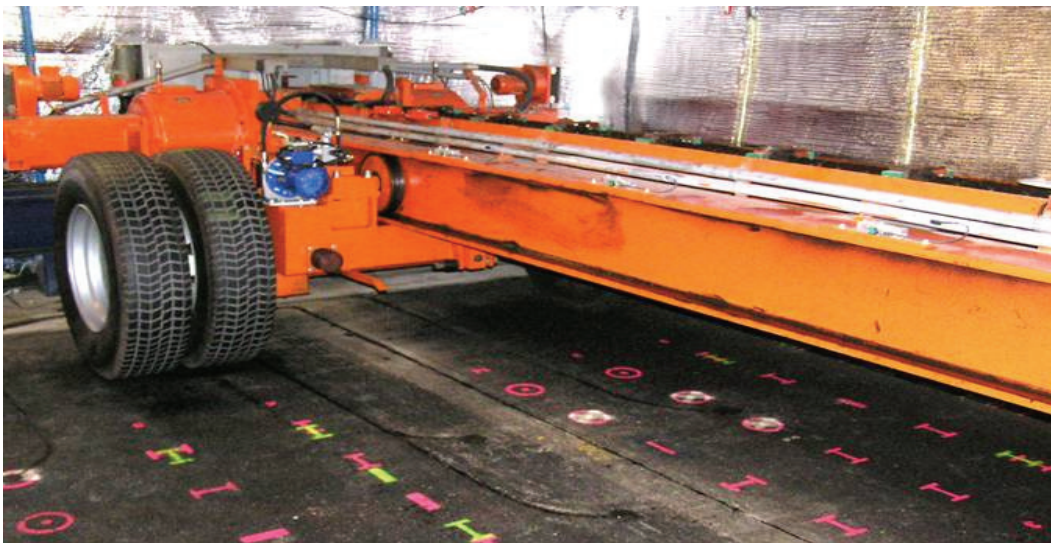
Abb. 6.40 Verkehrslastsimulator Halle Fosse (Verkehrslastsimulation im Massstab 1:1, EPFL, LAVOC)
