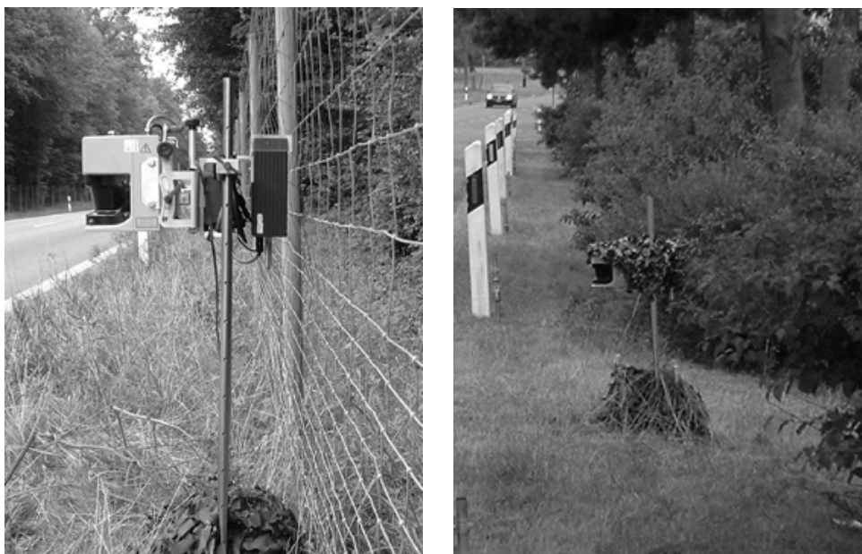
Abbildung 14: LMS mit Lasersensor und Erfassungsrechner (links), getarnt (rechts)
