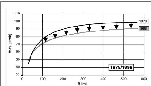
Die  $V_{85\%}$ -Werte liegen 1998 bei  $R >$  ca. 100 m bis zu 10 km/h tiefer als 1978 (Skizze links).
