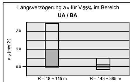
Der U-förmige Geschwindigkeitsverlauf ist bei Kurven mit Radien  $>$  ca. 140 m praktisch nicht mehr vorhanden.
