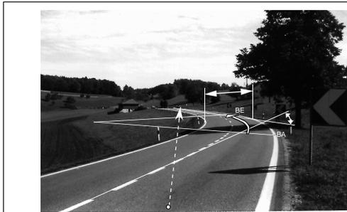
Deutliche Zusammenhänge haben sich bei den Winkeln der Richtungsänderung und bei der Kreisbogenlänge gezeigt. Eine teilweise Beeinflussung der Geschwindigkeiten in Kurven konnte auch bei der Fahrbahnbreite im Kreisbogen sowie bei den Sichtweiten festgestellt werden.
