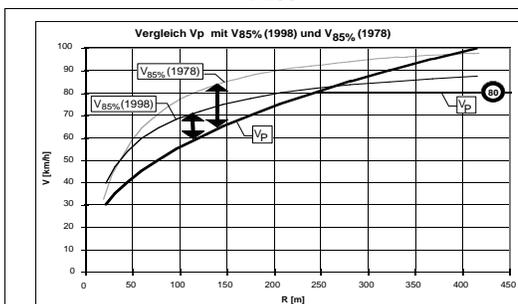
Die Abweichung der neuen, aufgrund von Messungen ermittelten Funktionskurve  $V_{85\%}$  (1998) von der Projektierungsgeschwindigkeit  $V_p$  gemäss Norm hat sich nach Einführung der Tempolimite 80 km/h deutlich verringert. Aus dieser Sicht drängt sich eine Anpassung des Zusammenhanges  $V_p = f(R)$  gemäss Modell der Norm nicht auf.
