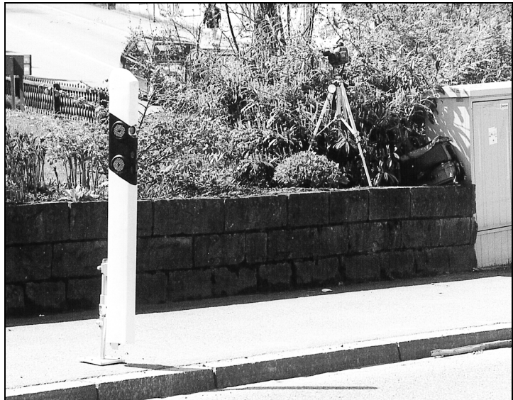
Abb. 4: Messpfosten und Videokamera im Einsatz
