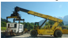
Abbildung 1: Vertikaler Umschlag Standardverfahren im unbegleiteten KV; wird z.B. bei Migros verwendet.
