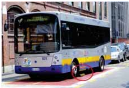
Abbildung 1: Batteriebus mit induktiver Aufladung an der Haltestelle
