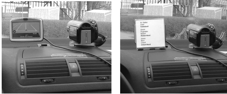
Abb. 4 Zielführung bei Versuchsfahrten mit Zielführungssystem „TomTom“ (links) und bei Fahrten nach Wegweisung mit Anzeige der Wegweiserinhalte im Fahrersichtfeld (rechts)
