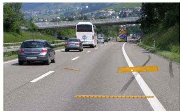
Abbildung 17: Beispiele von grossen Verschiebungen der Warnschwellen
