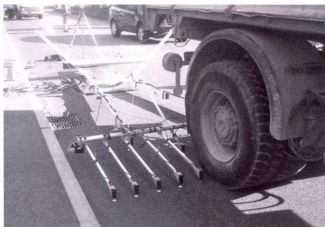
4 | ETH-Delta: Präzisionsmessgerät zur Aufnahme der dreidimensionalen Deflektionsmulde unter realer Belastung.
