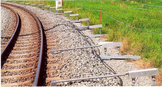
2 | Messstelle des IVT zur Analyse der Gleislagestabilität bei hohen Temperaturen, Bahnstrecke Biel-Täuffelen-Ins.
