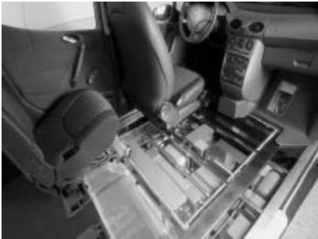
Abbildung 18: Innenleben des NECAR 4, DaimlerChrysler (2001a)
